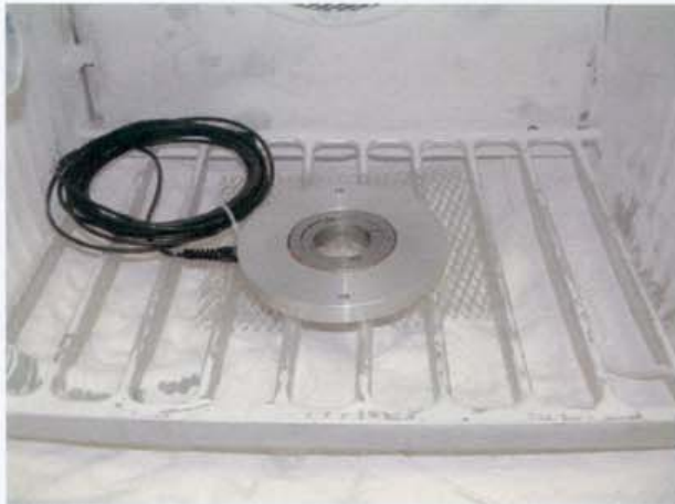
Bild 1 Drehimpulsgeber MHG 100 in der Staubkammer SK 160 zu Beginn der Staubschutzprüfung IP 5X
