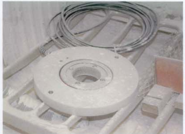
Bild 2 Drehimpulsgeber MHG 100 in der Staubkammer SK 160 nach der Staubschutzprüfung IP 5X
