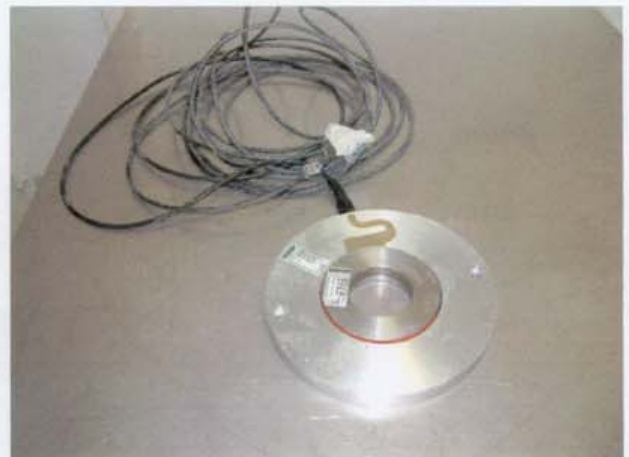
Bild 4 Drehimpulsgeber MHG 100 nach den Prüfungen zum Nachweis der Schutzart IP 58
